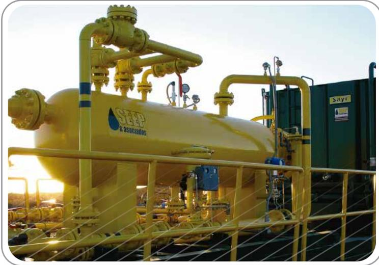
Este equipo es una unidad compacta montada sobre semi-remolque deprimido que esta compuesto por un chocke manifold en la entrada de fluidos, la unidad de separación trifásica y dos piletas de calibración de producción de líquidos (Guage Tank).
